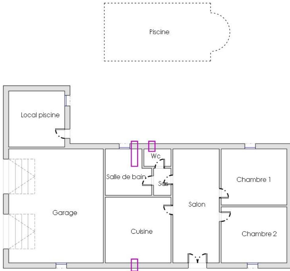
**ZPSO-001 - Conduit de ventilation en fibres-ciment**
