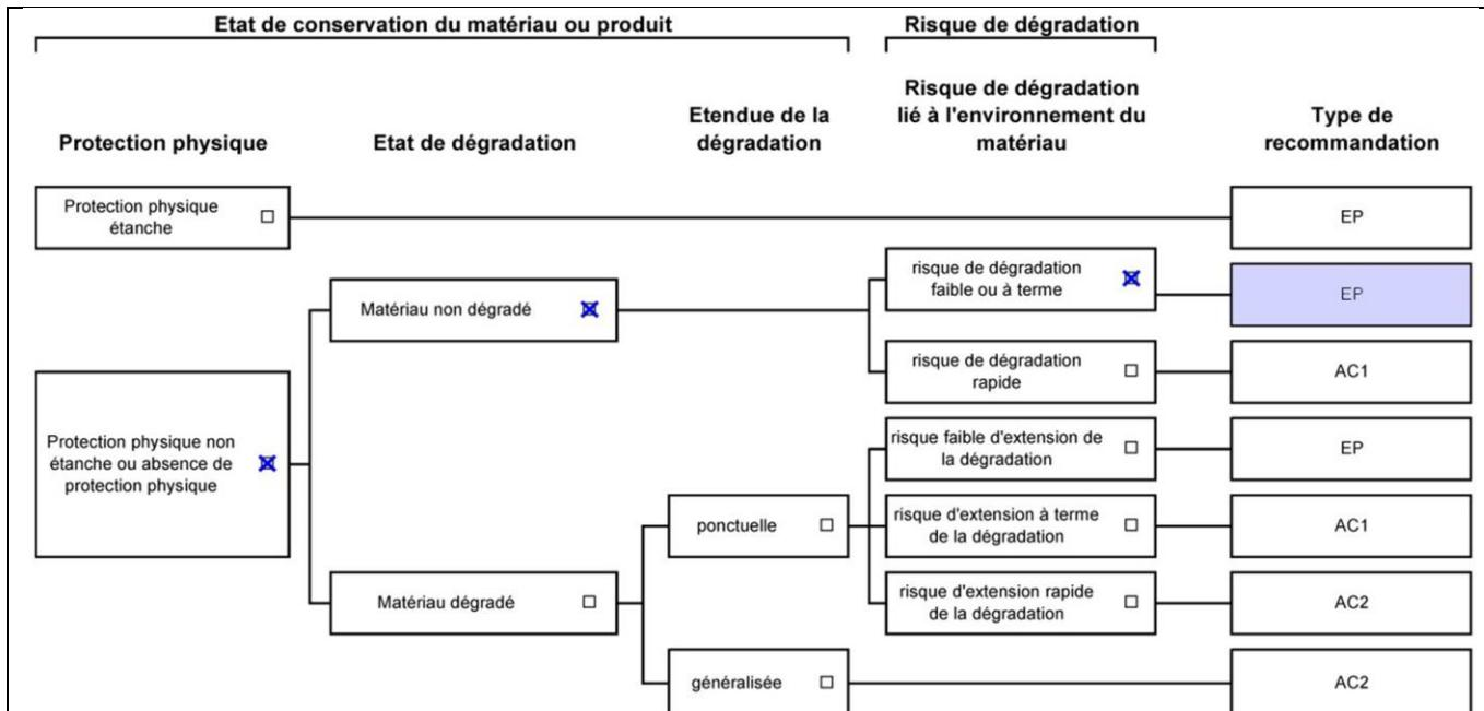
**Dossier n° 2019/02/18 PLAIR****Date de l'évaluation : 18/02/2019****Bâtiment / local ou zone homogène : Toiture extérieur****Identifiant Matériau : M001****Matériau : Conduits de cheminée****Résultat EP : Il est recommandé de réaliser une évaluation périodique.**
